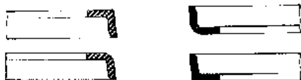
图 2 现代皮碗断面：夹布橡胶皮碗（左）和橡胶皮碗（右）
