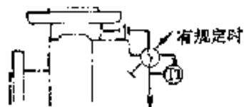
方案21 从泵壳经节流孔和冷却器向密封处循环
