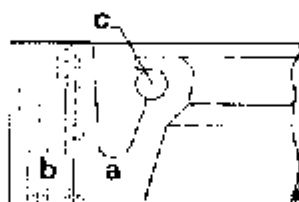
弹簧加载的唇形密封。(a) 合成橡胶部分；它以夹布橡胶 (b) 为骨架；(c) 不锈钢弹簧。
