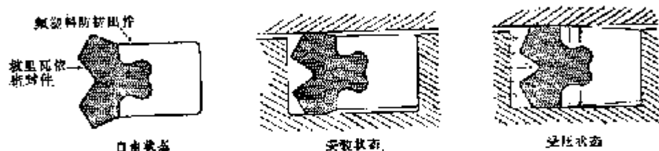
图20 楔形作用密封圈的密封原理
