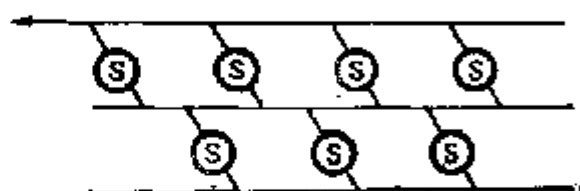
图3 说明硫化环的二维图形,其中橡胶分子链被硫桥(S)“焊接”起来
