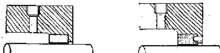
金属衬套密封 (左) 和聚四氟乙烯衬套密封 (右)。 后者通常配有防转动销钉。
